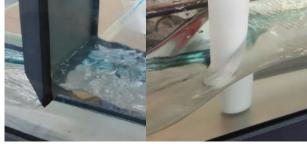
FLOW UNDER A SLUICE GATE
