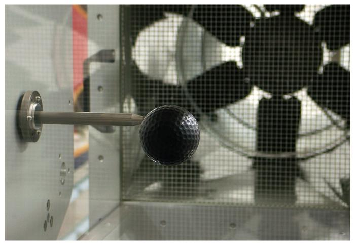
DIMPLED SPHERE DRAG MODEL (FROM AF1300J) SHOWN INSIDE THE TECQUIPMENT AF1300 WIND TUNNEL.
